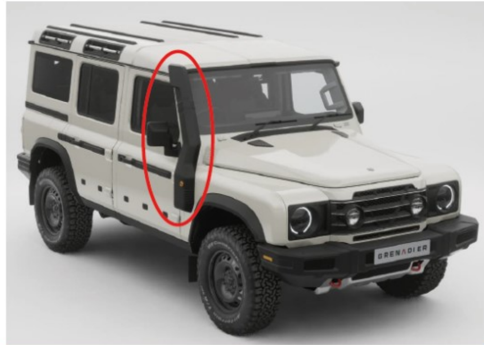
Prise d'air surélevée montée sur le pilier A
